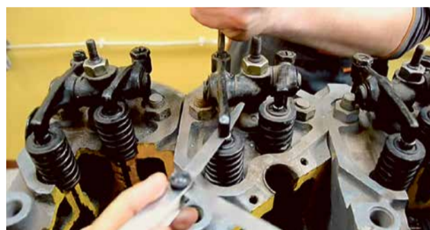
Widok głowicy z zaworami silnika w ciągniku Ursus C 360
