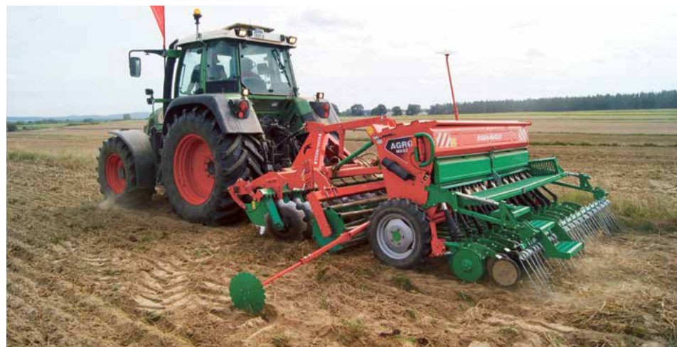
■ Powszechnym rozwiązaniem są agregaty uprawowo-siewne wyposażone w sekcję z broną talerzową
