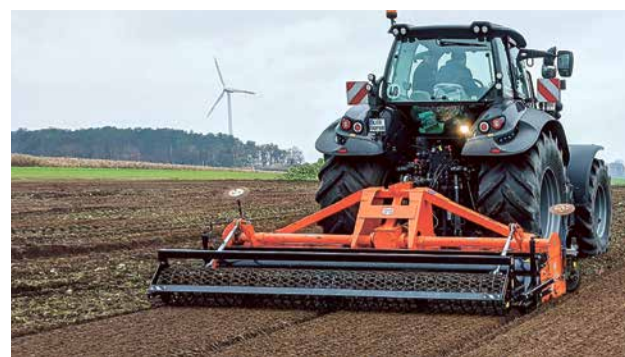
■ Zadania wymagające wysokiej precyzji doboru prędkości jazdy to pole do popisu dla przekładni CVT
