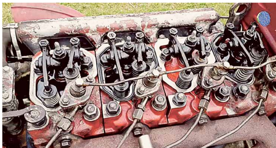
Regulację luzu zaworowego w silniku ciągnika dokonuje się przy pomocy szczelinomierza, wkrętaka i klucza płaskiego
