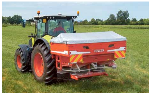
■ Maschio Gaspardo Primo EZ to rozsiewacz z elektroniczną kontrolą ważenia, który umożliwia zmienne dawkowanie nawozu w czasie pracy
