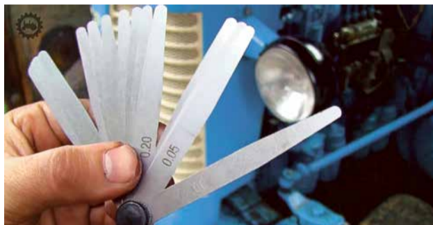
Podstawowym narzędziem do regulacji luzu zaworowego jest szczelinomierz
