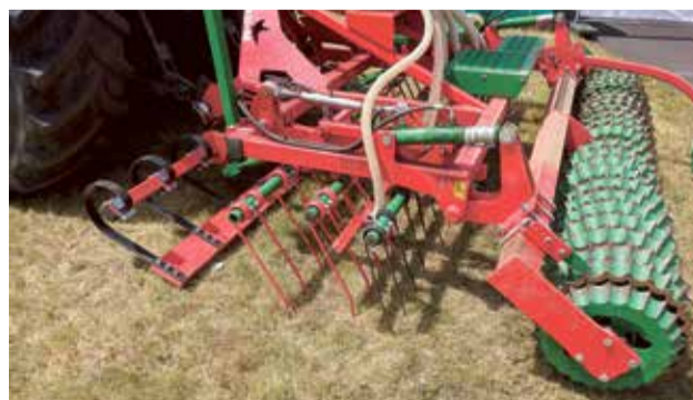
Siewniki do podsiewu traw mają zróżnicowaną konstrukcję, od prostych, łączących bronę z siewnikiem rzutowym i wałem, po zaawansowane maszyny z redlicami tarczowymi lub sekcjami pozwalającymi na uprawę pasową
