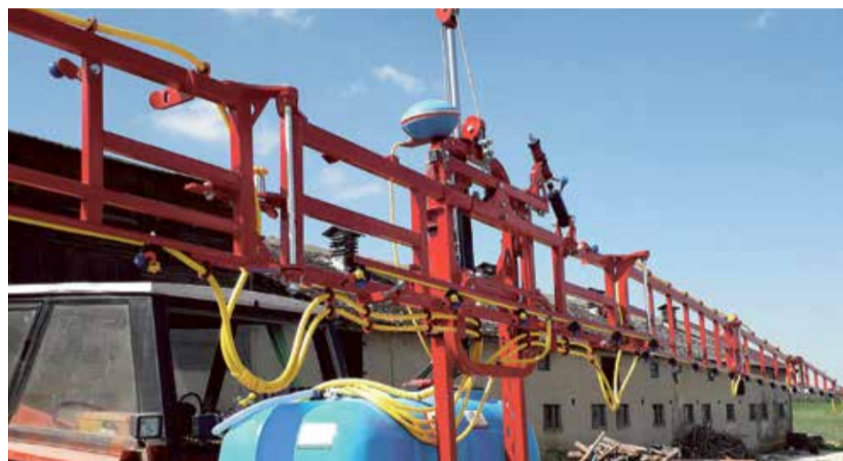
Fot. 2. Proste rozwiązanie hydraulicznego podnoszenia belki połączone ze składaniem ręcznym
