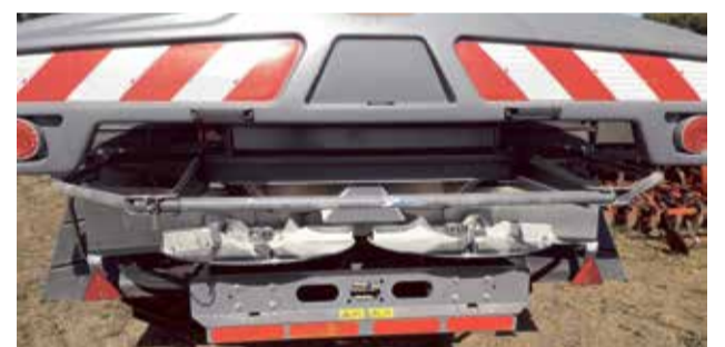
■ Fot. 2. Tarcze rozsiewacza wielkogabarytowego
