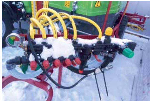
Fot. 1. Manualny układ zaworów
