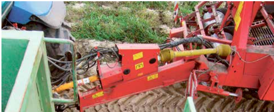
■ Przeniesienie napędów wewnątrz maszyny/kombajnu ziemniaczanego pod różnymi kątami umożliwiają wały przegubowo-teleskopowe
