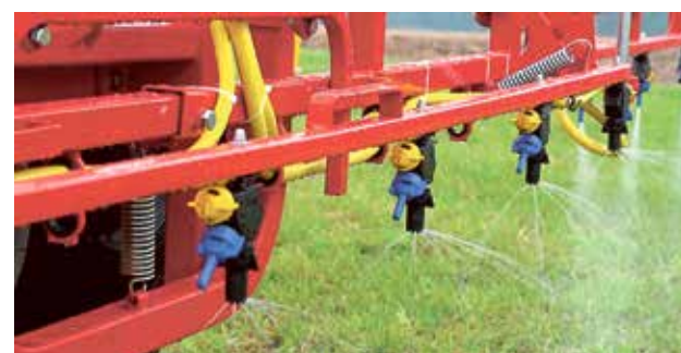
■ Różne rozpylacze zainstalowane na belce opryskiwacza pozwalają na szybką ich wymianę w zależności od warunków
