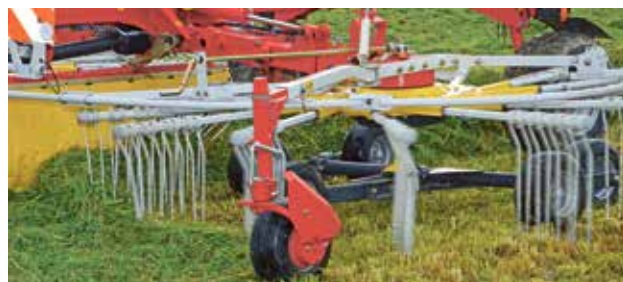
■ Zaawansowane, niezależne układy jezdne karuzel, pozwalają na bardzo dokładne kopiowanie powierzchni terenu
