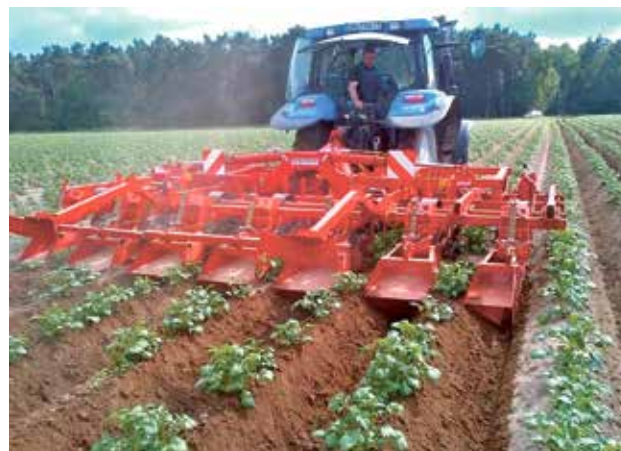
■ Zadaniem obsypnika – pielnika jest formowanie i odtwarzanie redlin z równoczesnym niszczeniem chwastów przez elementy spulchniające w uprawie redlinowej
