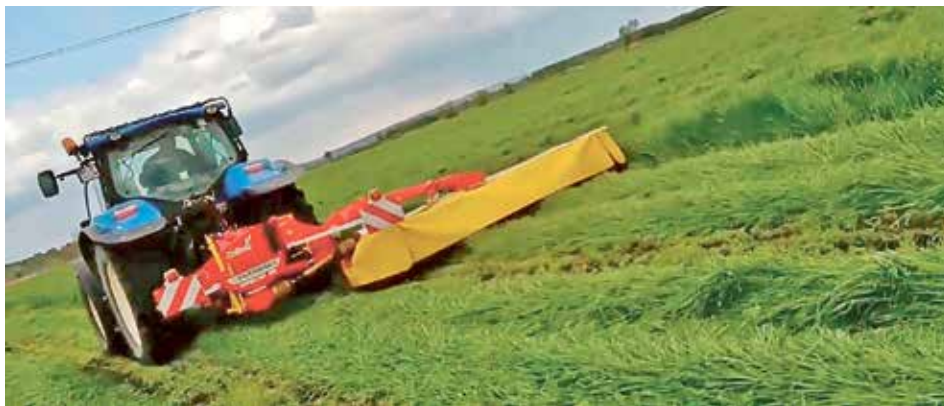
■ W kosiarkach bębnowych proces skoszonej zielonki przebiega zwężonym pokosem, co wymaga w dalszym etapie bardziej agresywnej pracy przetrząsaczy
