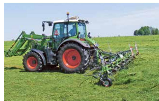
■ Przetrzęsacz karuzelowy jest jedną z najlepszych maszyn do rozrzucania i poruszania pokosów ze względu na równomierność rozrzucania
