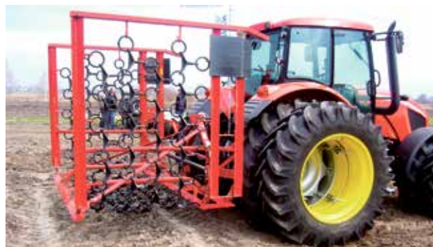
■ Włókobrona chwastownik dzięki luźno zawieszonym segmentom z trójstronnymi gwiazdami, skutecznie niszczy wschodzące chwasty w uprawach polowych i łąkach na całej powierzchni
