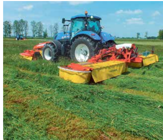
■ Istnieje możliwość zagregatowania równocześnie trzech kosiarek rotacyjnych dyskowych do jednego ciągnika, co daje wysoką wydajność koszenia
