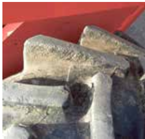
■ Wyraźnie zniszczone ogumienie maszyny demonstracyjnej
