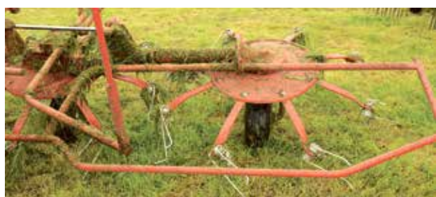
■ Palce przetrzęsacza powinny pracować nieco ponad powierzchnią ziemi. Drapanie gleby powoduje uszkodzenie darni oraz zanieczyszczenie paszy
